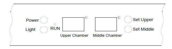
"RUN": Cuando se ilumina indica que el sistema de enfriamiento está en funcionamiento.
