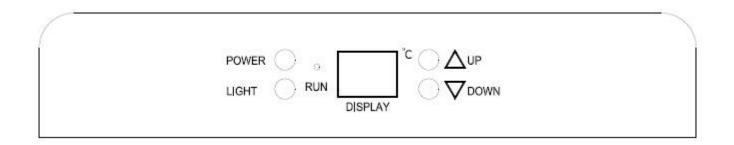
"RUN": Cuando se ilumina indica que el sistema de enfriamiento está en funcionamiento.
