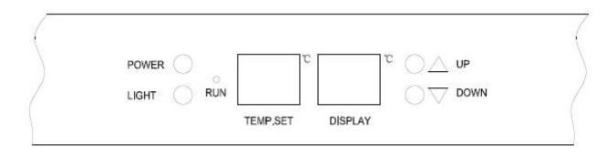
"RUN": Cuando se ilumina indica que el sistema de enfriamiento está en funcionamiento.
