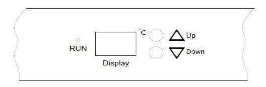
**"RUN":** Cuando se ilumina indica que el sistema de enfriamiento está en funcionamiento.
